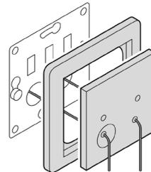
4 Führen Sie die Schnurstücke durch den Abdeckrahmen und durch die Frontplatte.
