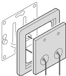
**2** Führen Sie die Schnurstücke durch den Abdeckrahmen und durch die Frontplatte.
