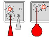
Ziehen Sie die rote Zugschnur bzw. drücken Sie den Pneumatikbalg.
