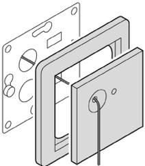
4 Führen Sie das Schnurstück durch den Abdeckrahmen und durch die Frontplatte.
