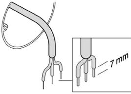
1 Manteln Sie die Kabelenden ab und isolieren Sie die Leitungen ab.
