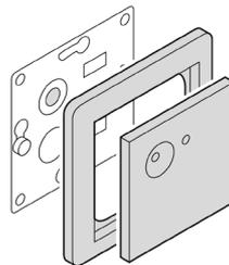
**4** Platzieren Sie den Ab-deckrahmen und ste-cken Sie die Front-platte auf.
