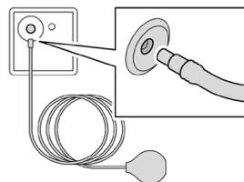
**6** Stecken Sie den Pneumatikschlauch auf.
